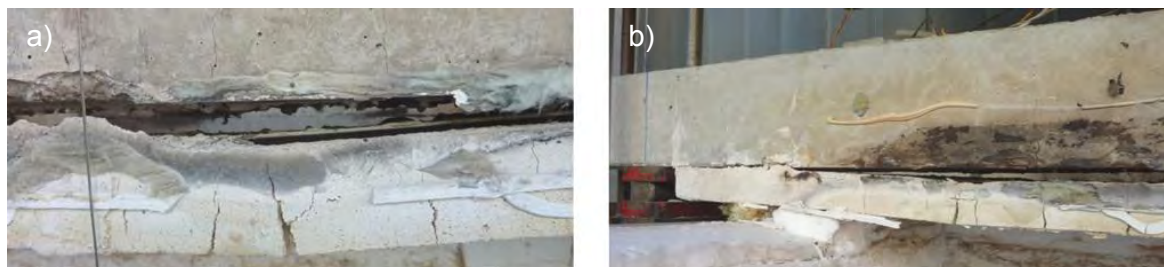
Figura 4.70. Viga VP40 : a) perda de aderência betão-resina na zona central da viga; b) comparação do aspecto do sistema de protecção nas zonas de extremidade do laminado e central da viga.
