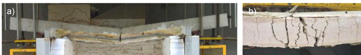
Figura 4.68. Viga VP25 : a) rotura por flexão da viga; b) vista inferior do sistema da argamassa de vermiculite e perlite após o ensaio de resistência ao fogo.
