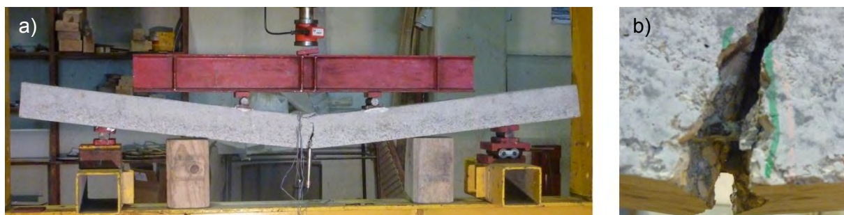
Figura 4.31. a) vista geral da rotura da viga VA; b) pormenor da rotura da armadura longitudinal inferior.
