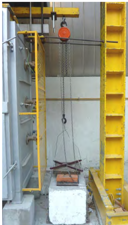
Figura 4.47. Sistema de suspensão dos pesos numa das extremidades da viga de distribuição (nesta figura são visíveis os pesos utilizados nos ensaios às vigas reforçadas).
