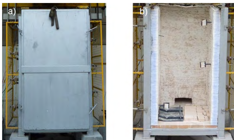
Figura 4.39. a) Vista exterior do forno; b) vista interior do forno através da abertura frontal.
