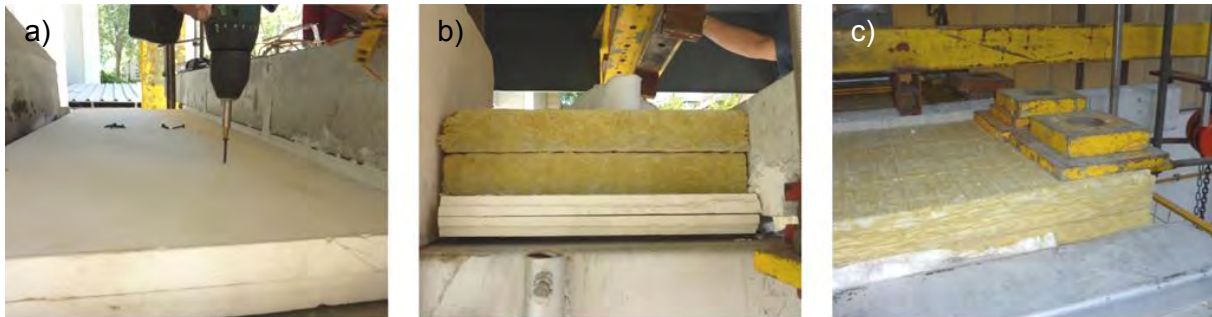
Figura 4.43. a) aparafusamento das placas de silicato de cálcio para isolamento lateral; b) disposição das diferentes placas de isolamento lateral nos ensaios das vigas VP40 e SC40; c) pesos nas extremidades das placas de isolamento lateral.
