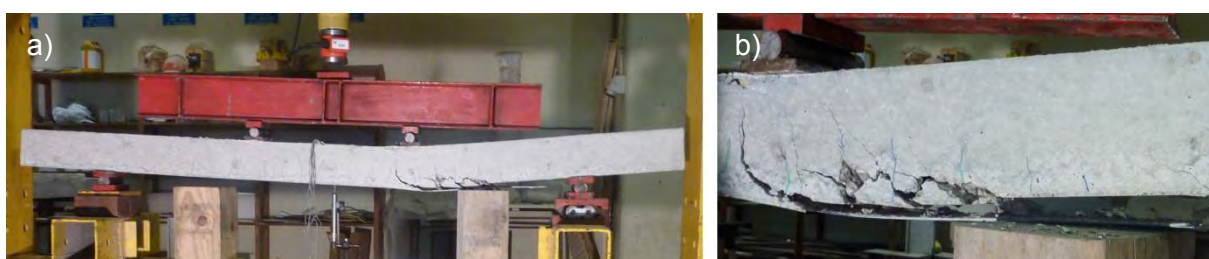
Figura 4.32. a) vista geral da rotura da viga VB; b) pormenor do descolamento da extremidade do laminado com arrancamento de betão.
