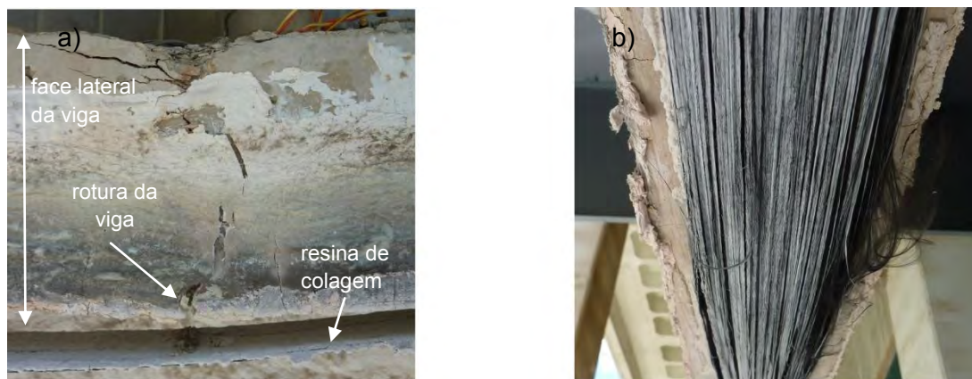
Figura 4.67. Viga CFRP : a) rotura por flexão da viga, onde se observa a resina de colagem ainda aderente ao laminado; b) decomposição da matriz polimétrica do laminado deixando expostas as fibras de carbono.
