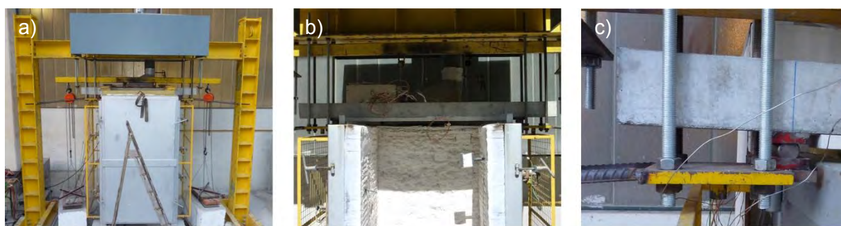
Figura 4.40. a) pórtico envolvente ao forno e campânula aplicada na travessa; b) vista geral da viga sobre o forno; c) pormenor dos apoios da viga.
