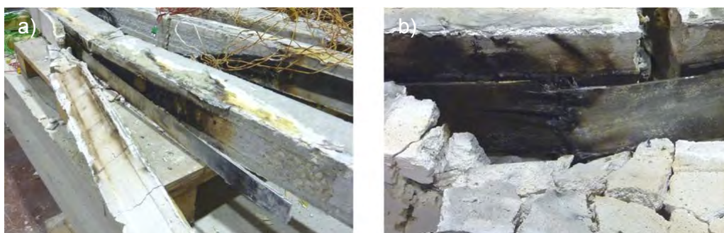
Figura 4.69. Viga VP25 : a) rotura do reforço por descolamento da extremidade; b) pormenor dos cortes nas fibras numa secção central.
