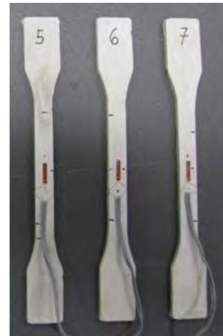
Figura 4.3. Localização dos extensómetros nos provetes EP5 a EP7.
