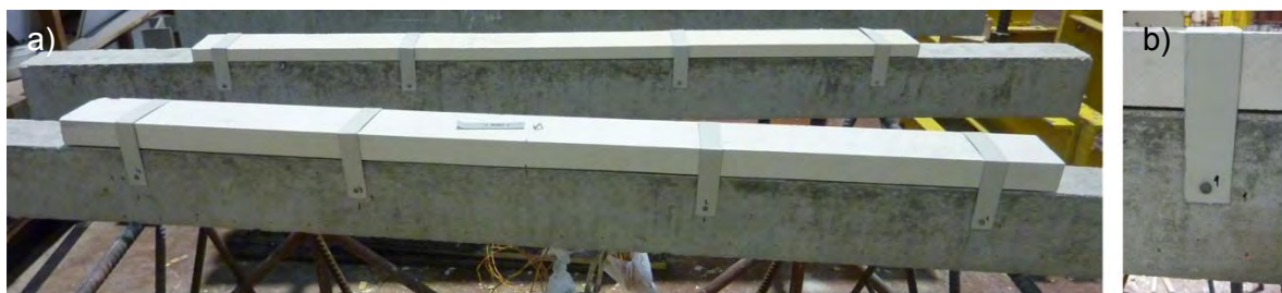
Figura 4.36. a) vista geral das vigas SC25 e SC40, protegidas com painéis de SC fixados mecanicamente; b) Pormenor do sistema de fixação mecânica.
