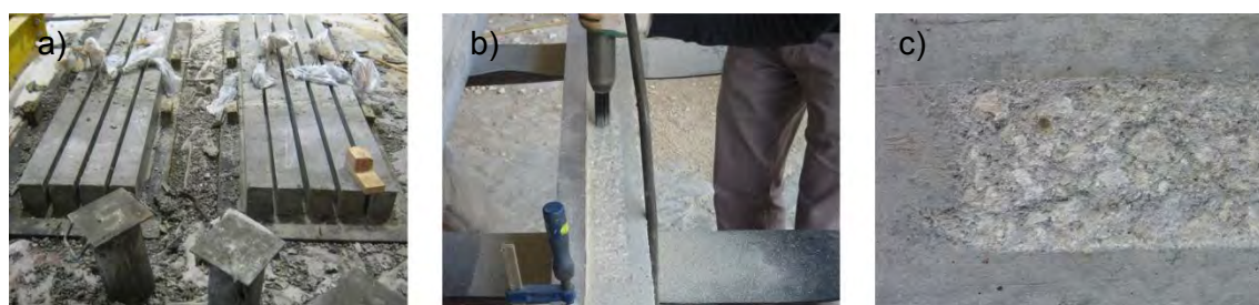
Figura 4.26. a) vigas após descofragem; b) preparação da superfície do betão com martelo de agulhas; c) aspecto da superfície do betão após preparação com martelo de agulhas.
