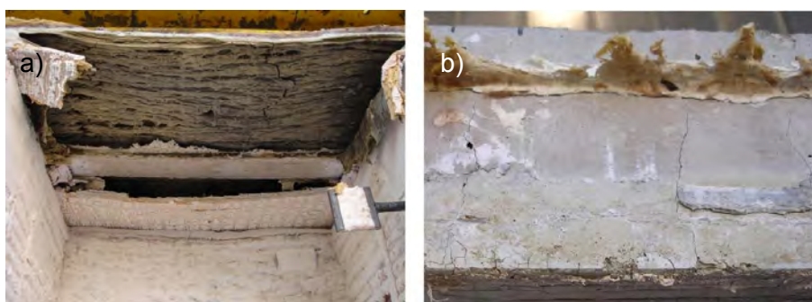
Figura 4.65. Viga RC: a) destruição do sistema de isolamento lateral; b) fendilhação na zona central da viga e desagregação de betão nas arestas inferiores.
