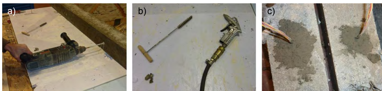
Figura 4.34. a) execução dos furos para colocação dos termopares T1" e T2" com berbequim eléctrico; b) instrumentos utilizados para limpeza dos furos; c) selagem dos furos com calda de cimento.
