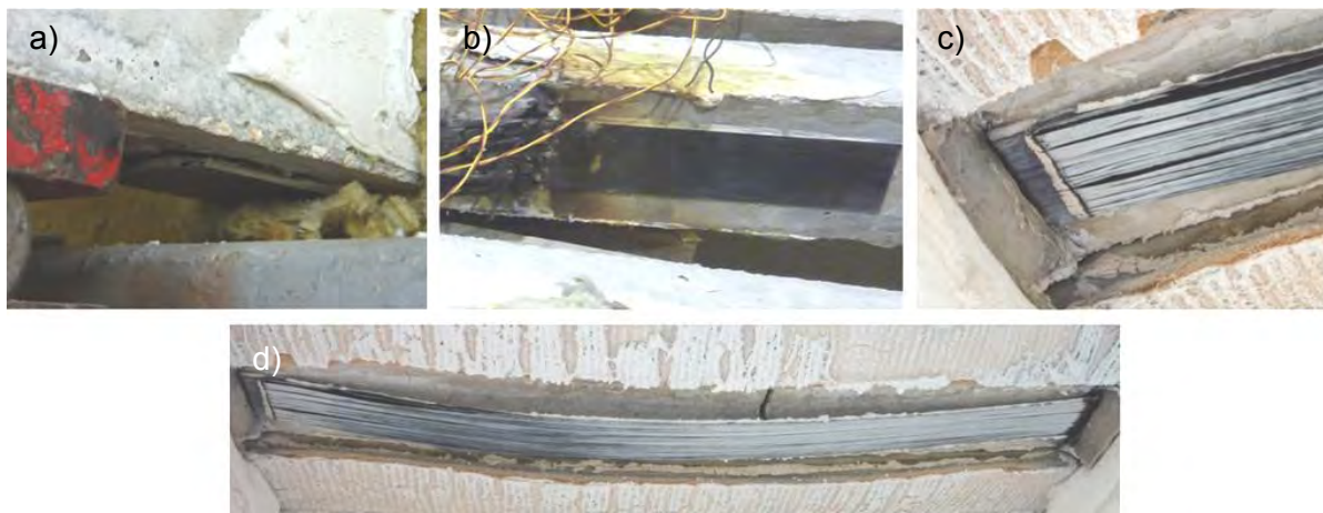
Figura 4.66. Viga CFRP : a) descolamento da extremidade do laminado; b) comprimento do laminado que ficou protegido; c) isolamento do laminado na zona da parede do forno; d) zona central do laminado completamente destacada da viga.
