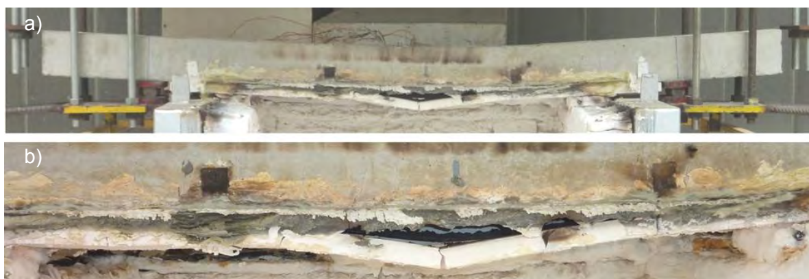
Figura 4.71. Viga SC25 : a) aspecto geral da Viga SC25 após o ensaio; b) detalhe da zona central da viga com colapso eminente do sistema de protecção.
