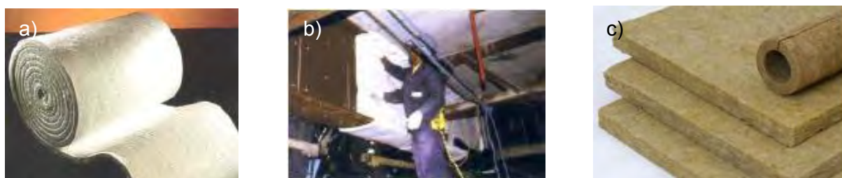
Figura 3.21. a) rolo de manta de fibras cerâmicas; b) perfil metálico envolvido com mantas cerâmicas; c) placas de lã de rocha [3.35].
