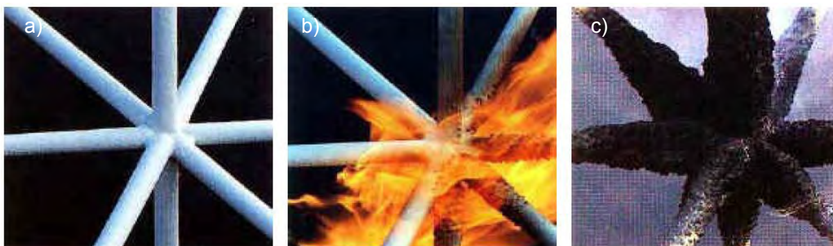
Figura 3.18. a) aspecto inicial de tubos metálicos protegidos com tinta intumescente; b) acção do fogo nos tubos metálicos; c) aspecto final da tinta intumescente após a acção do fogo [3.31].
