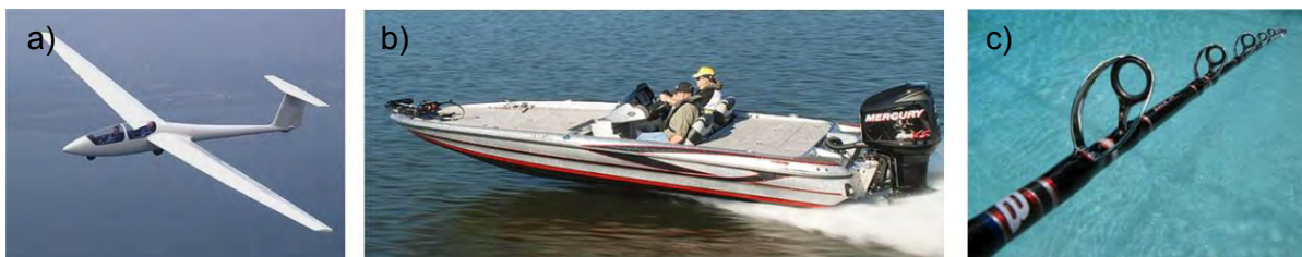
Figura 2.3. a) utilização de materiais compósitos em planadores [2.11]; b) barco de recreio com casco totalmente em compósito de fibras de vidro [2.12]; c) cana de pesca em compósito de fibras de carbono [2.13].
